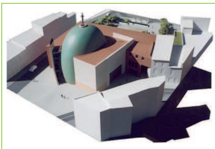
Eglise de la Ste famille d'Istre, modélisation du comportement dynamique sous sollicitation sismique, équipe CMGD, EMA
